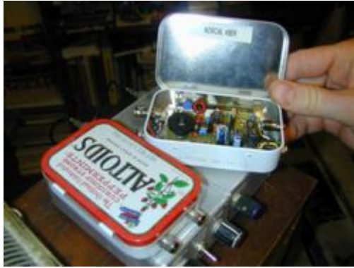
Transceptor casero construido por K6ESE
