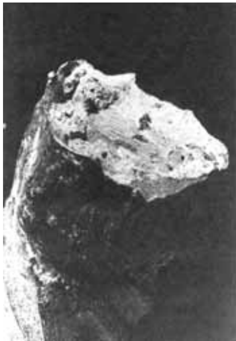
Figura 39. Fractura de una varilla de grueso calibre en soldadura. La regla de oro de los buenos soldadores indica que la unión de dos piezas debe resultar más resistente que las piezas mismas. Si alguna fuerza de magnitud inesperada provocara la ruptura, la línea de fractura debería quedar fuera del área de la soldadura.
