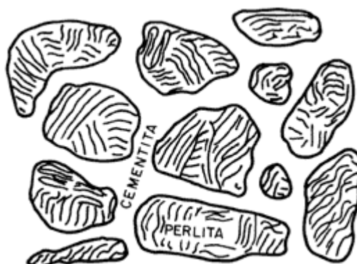
Figura 10. Simulación de una metalografía de un acero con estructura de granos de perlita embebidos en una matriz de cementita.
