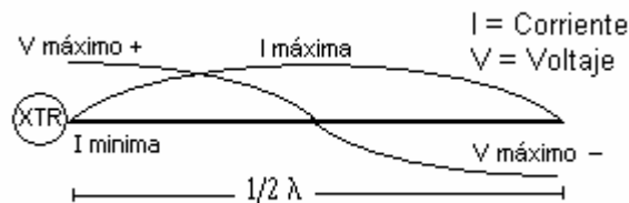
Fig. 21: Distribución de la corriente y del voltaje a lo largo de la antena:
