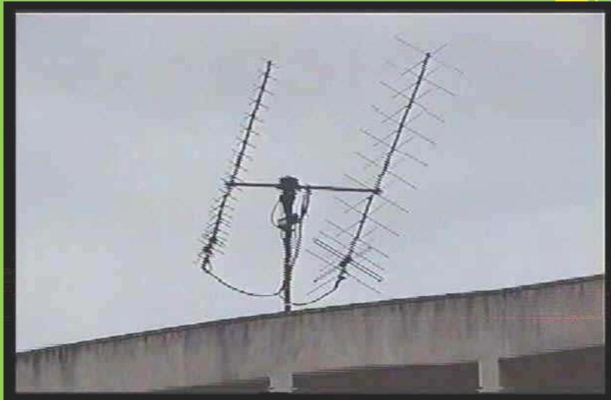
Ilustração 21 – Antenas de VHF e UHF cruzadas faseadas em polarização axial direita para satélite. Com rotor azimuthal e elevação.
