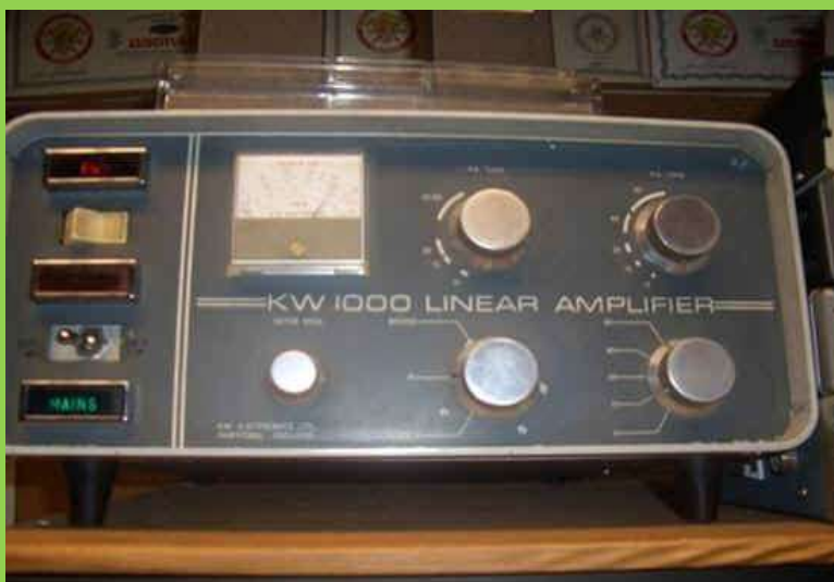
Ilustração 14 – Linear a debitar 900W na antena ( CONTINUOS)
