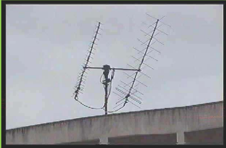
Ilustração 20 – Antenas de VHF e UHF cruzadas polarização axial direita para Satélite
