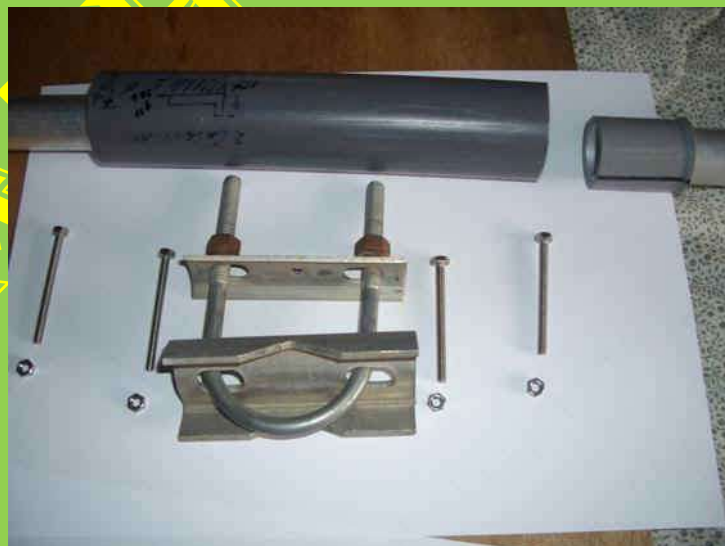
Ilustração 5 - SEPARADOR CENTRAL DO DIPOLO COM CASQUILHOS PARA RECEBER TUBOS DE ALUMINIO
