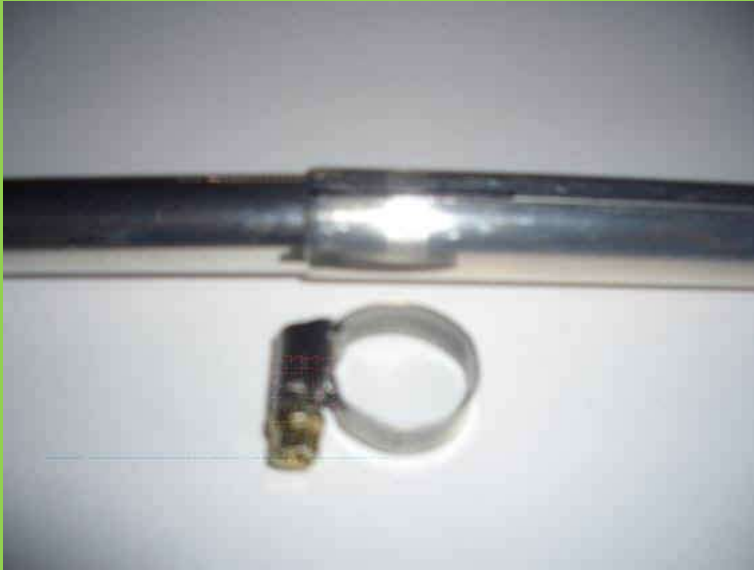
Ilustração 6 - UNIÃO DOS TUBOS DE ALUMINIO COM ABRAÇADEIRA (telescópicos)
