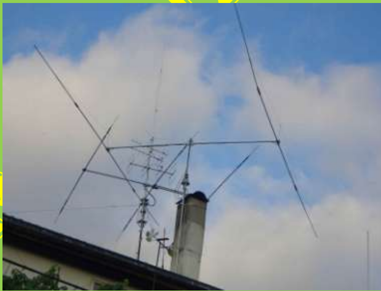
Antena dos 40 e 80 metros no mesmo Boom, dipolos suportados com fio de nylon de 2m/m
