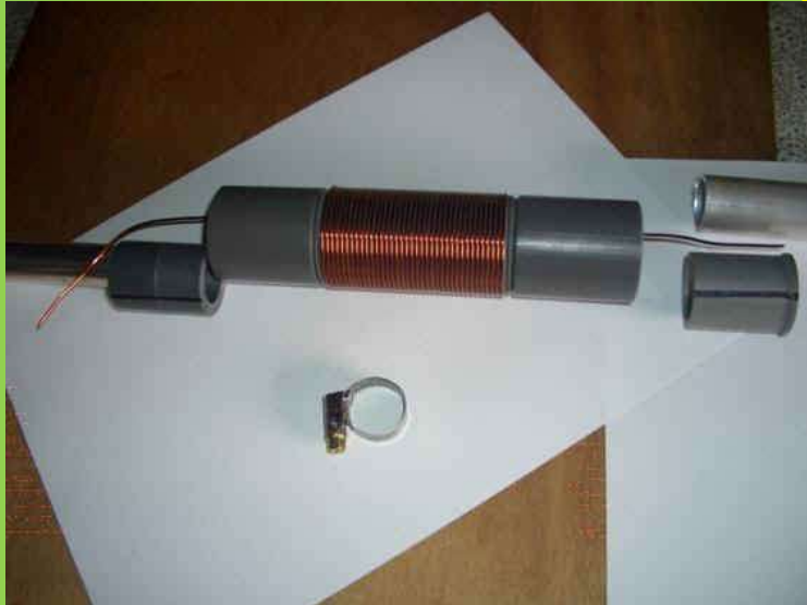
Ilustração 7 - BOBINA COM PASSO DE ROSCA ESPAÇADO 1M/M E CASQUILHOS PARA OS DIAMETROS DOS TUBOS DE ALUMINIO
