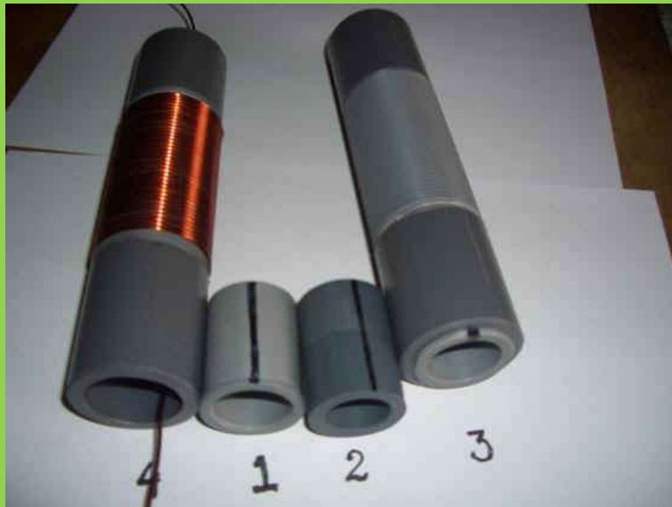
Ilustração 3 - CASQUILHOS 1 e 2 de 20 e 25 m/m, bobina já com enrolamento fio 1,6 e uma sem o fio, o traços pretos em 1 e 2 é para abrir rasgo para passar fio da bobina que vai ligar ao tubo de alumínio, mais de 200w é por 1 casquilho inteiro de nylon fóra a fóra
