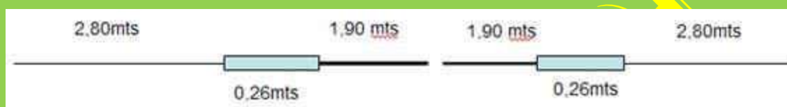
Fig. 2 Antena BPJ/GLH 80mts
