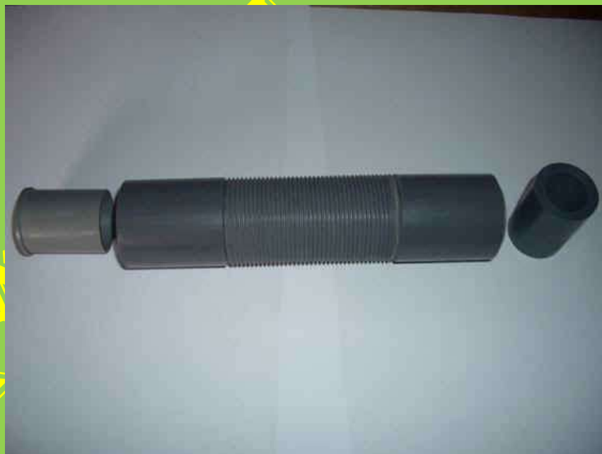
Ilustração 2 - Bobina com a rosca espaçada 1m/m e os casquilhos para receber os tubos de 20 e 25 m/m de diâmetro
