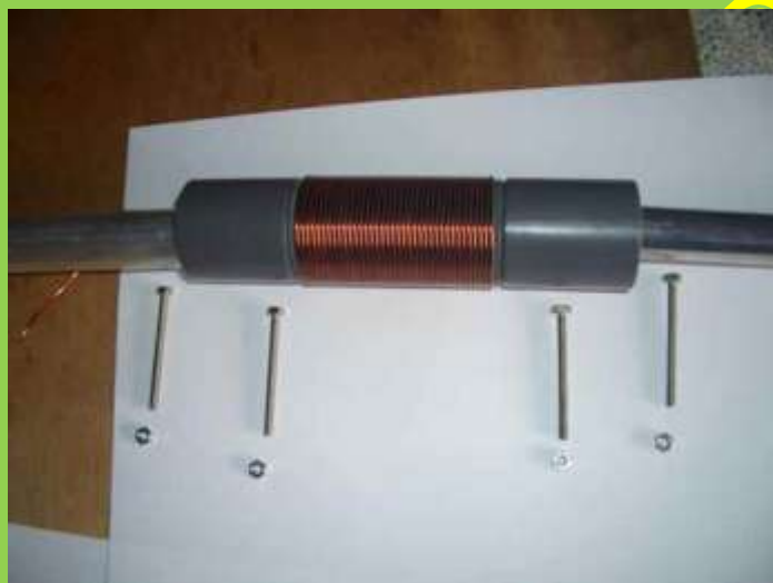
Ilustração 4 - BOBINA COM OS TUBOS DE ALUMINIO E PARAFUSOS INOX 4x50 e 4x30
